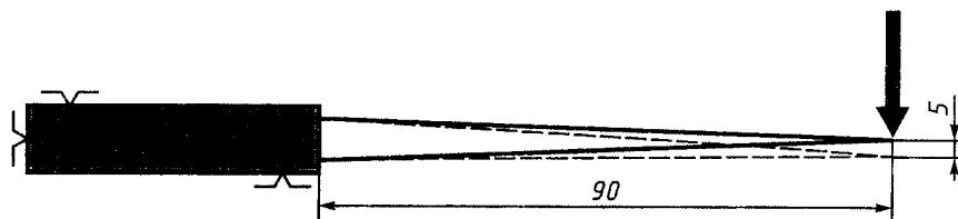
Рисунок 6 — Схема проведения испытаний на прочность и упругость разделочных и шкуросъемных ножей.
